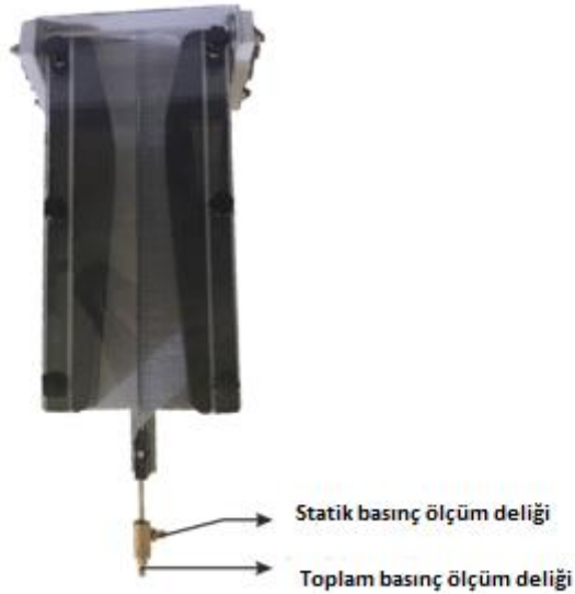
Şema 1: Pitot-Statik basınçölçerin şematik gösterimi
