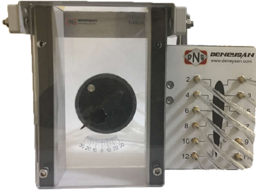
Şekil 4:Kanat profilinin taşıma katsayısı hesabında kullanılan deney modülü
