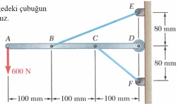
3. Şekildeki gibi yüklenmiş olan  $ACB$  çubuğu dengede olduğuna göre  $AD$  kablodaki çekme kuvveti  $T$  yi ve  $C$  mesnedindeki tepki kuvvetinin şiddetini hesaplayınız.
