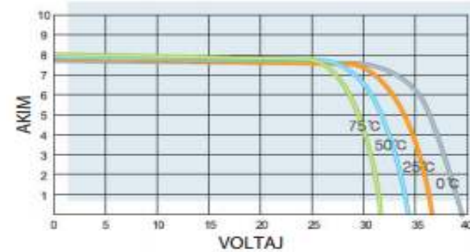
Şekil 3-13: Polikristal bir fotovoltaik modülün teknik özellikleri
