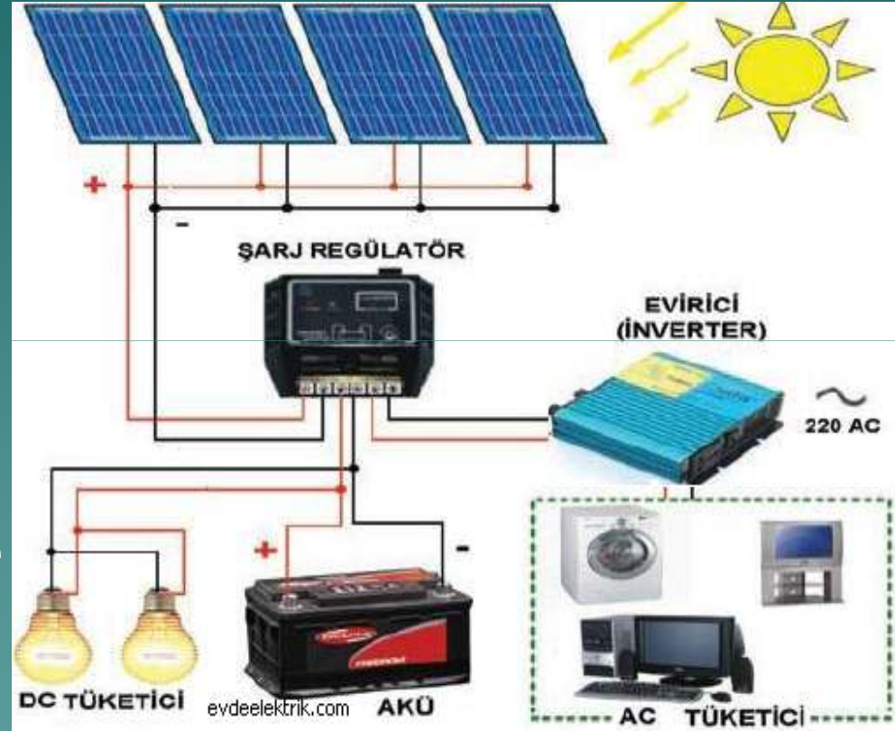
Şekil 3-1: Şebekeden bağımsız fotovoltaik enerji sistemi
