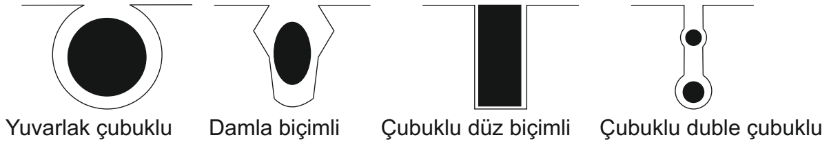
Şekil- 15.3 : Rotor çubuk biçimi ve kesiti
